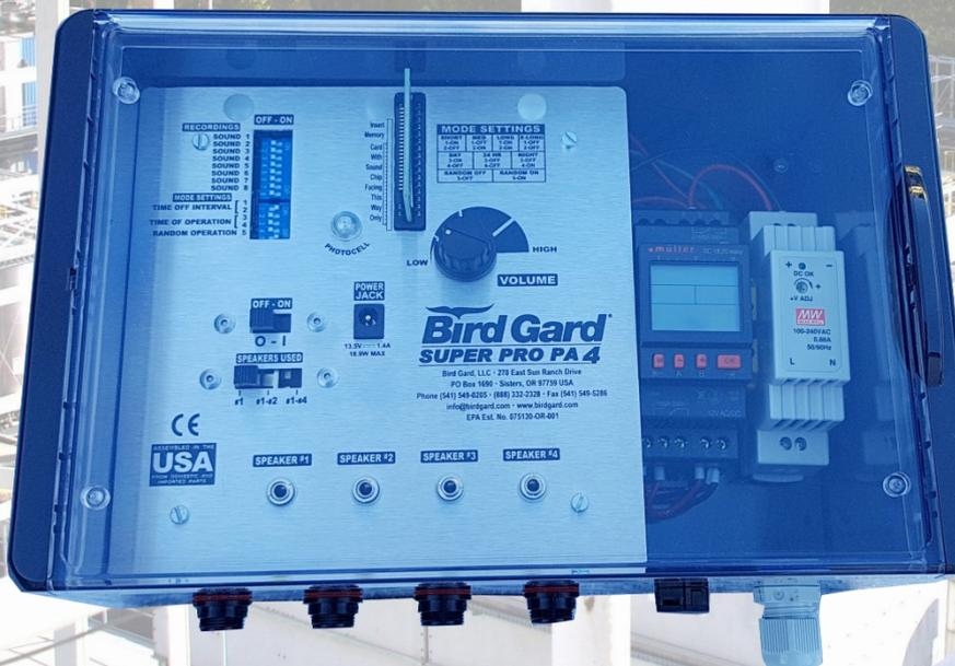
Durch die Wiedergabe unterschiedlicher, arteneigener Warnrufe und Panikschreie wird die Umgebung für die Vögel zu einer Gefahrenzone, die gemieden wird. Mithilfe diverser Einstellmöglichkeiten wird einer Gewöhnung entgegengewirkt.
